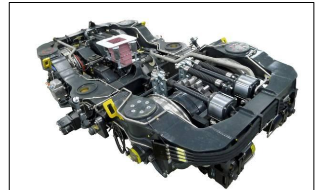
Zahnrad Triebdrehgestell mit Bremszahnrad, höhenverstellbar
